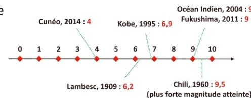
**Intensité** - Echelle descriptive des effets et dommages constatés du séisme sur les personnes, constructions et l'environnement.
