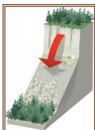
Chute de pierres et de blocs
