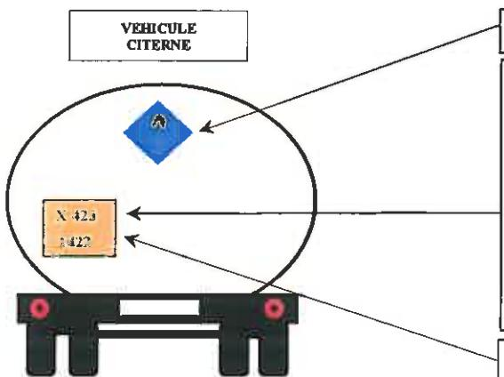
Cet exemple illustre le transport de matière solide inflammable, réagissant dangereusement avec l'eau, en dégageant des gaz inflammables (code de danger : X
