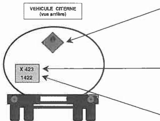
Cet exemple illustre le transport de matière solide inflammable, réagissant dangereusement avec l'eau, en dégageant des gaz inflammables (code de danger : X 423) : ici un alliage sodium -potassium (code matière : 1422).
