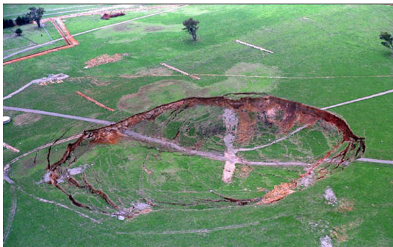
Effondrement de grande ampleur en surface de la mine d'Elura en Australie
