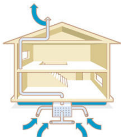
Drainage du radon par mise en dépression du sol sous-jacent au bâtiment.
