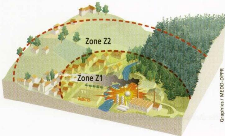
contrôles. Ils doivent ainsi réaliser une étude de danger dans laquelle ils identifient les accidents les plus dangereux pouvant survenir dans leur usine et leurs conséquences. Ces études leur permettent de prendre les mesures de prévention et de protection nécessaires, et de disposer en interne de moyens d'intervention permettant de faire face à un accident. Elles permettent également à l'Etat de mettre en place des plans de secours.
