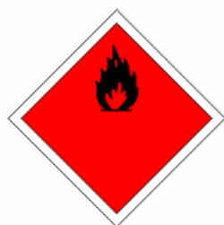
GAZ OU LIQUIDE INFLAMMABLE
