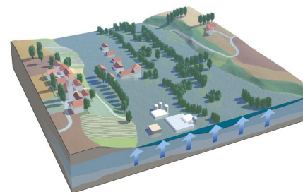
Inondation de nappe
