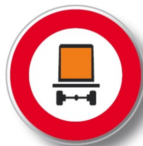
Véhicules transportant des matières dangereuses
