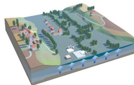
inondation de nappe
