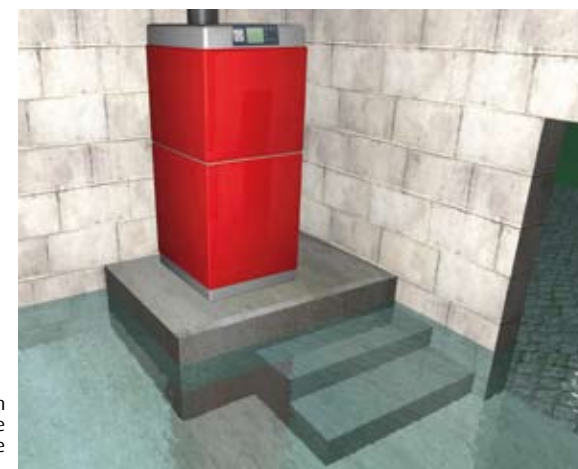
Protection d'un équipement de chauffage par surélévation.
