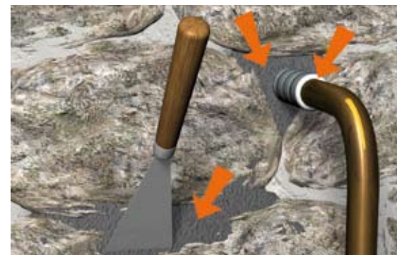
Situation après travaux : colmatage des voies d'eau.
