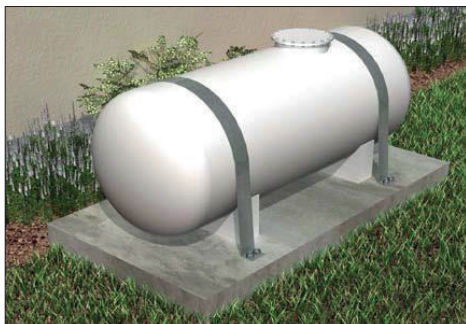
Arrimage des cuves de fioul
