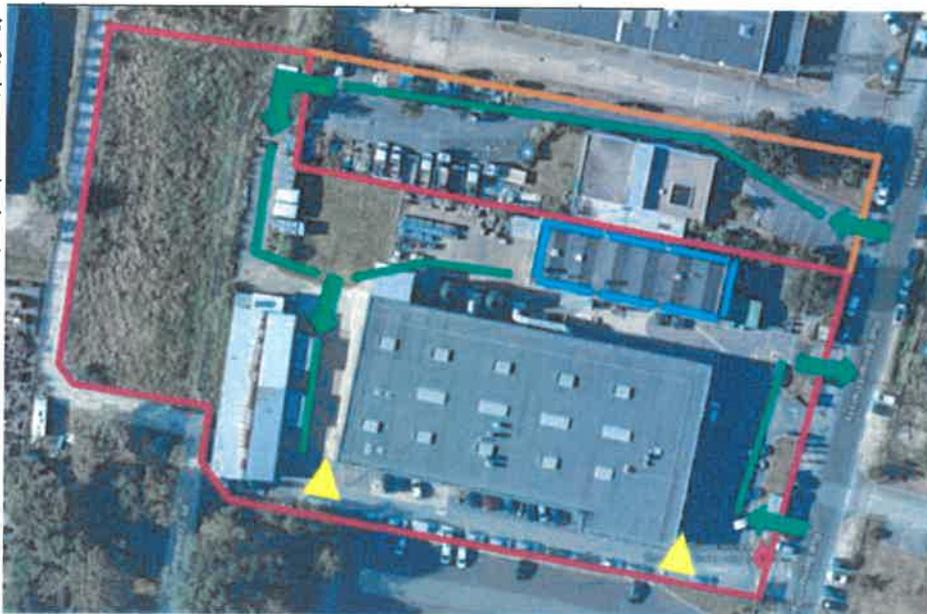
*Compte tenu de l'impossibilité de mise en place d'une voie "engins" permettant la circulation sur l'intégralité de la périphérie des bâtiments (notamment du bâtiment 1 dont la structure est susceptible de s'effondrer vers l'extérieur en cas d'incendie), l'exploitant met en place deux aires de retournement pour permettre aux engins du SDIS de se déplacer facilement.*
