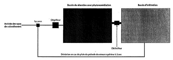
création, au sud-ouest du site, d'un bassin étanche de rétention des eaux pluviales avec phytoremédiation suivi d'un bassin d'infiltration (avec dégrilleur et déshuileur). Cette gestion des eaux pluviales ne concerne pas tout l'établissement; les secteurs concernés sont situés à l'ouest de l'établissement; ils représentent environ 3,5 ha déjà imperméabilisés.
