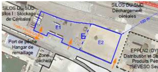
Les eaux pluviales sont par conséquent traitées par le même ouvrage, le « Séparateur d'hydrocarbures Quai Est I – Zone Arrière ». Les considérations du dossier initial restent les mêmes : cet ouvrage est adapté au traitement des rejets pluviaux chroniques pouvant émaner du terre-plein E (zones E1 et E2).
