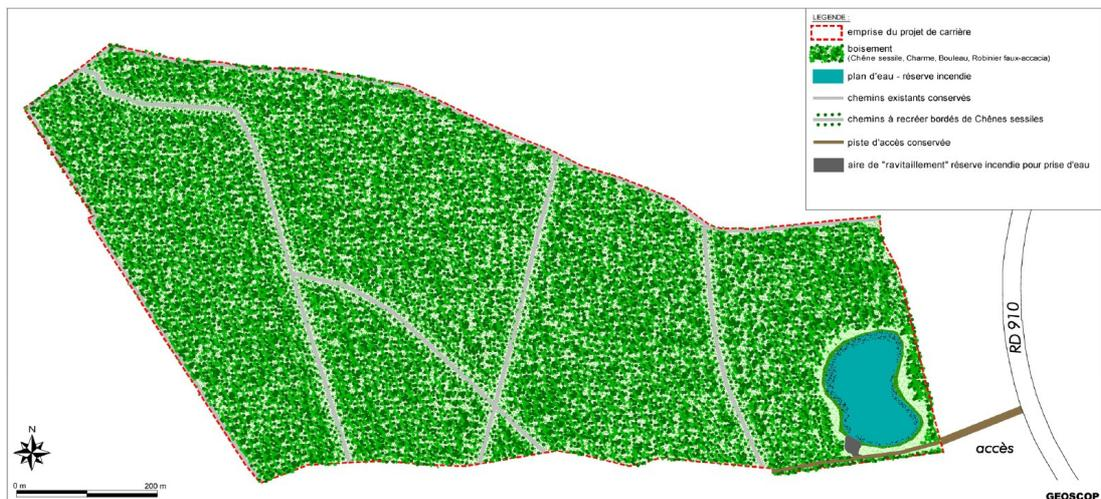
La topographie finale du site après remblaiement de l'excavation a été déterminée de manière à ce que les cotes finales soient situées globalement à  $\pm 1$  mètre au-dessus des cotes des plus hautes eaux enregistrées au niveau des 5 piézomètres implantés sur le site, afin de limiter les possibilités de remontée de nappe et maintenir ainsi la pérennité des futures plantations.
