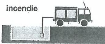
◆ Elles nécessitent la mise en oeuvre d'une aspiration, plus longue et plus délicate qu'un raccordement sur une prise d'eau alimentée par un réseau d'eau sous pression.
