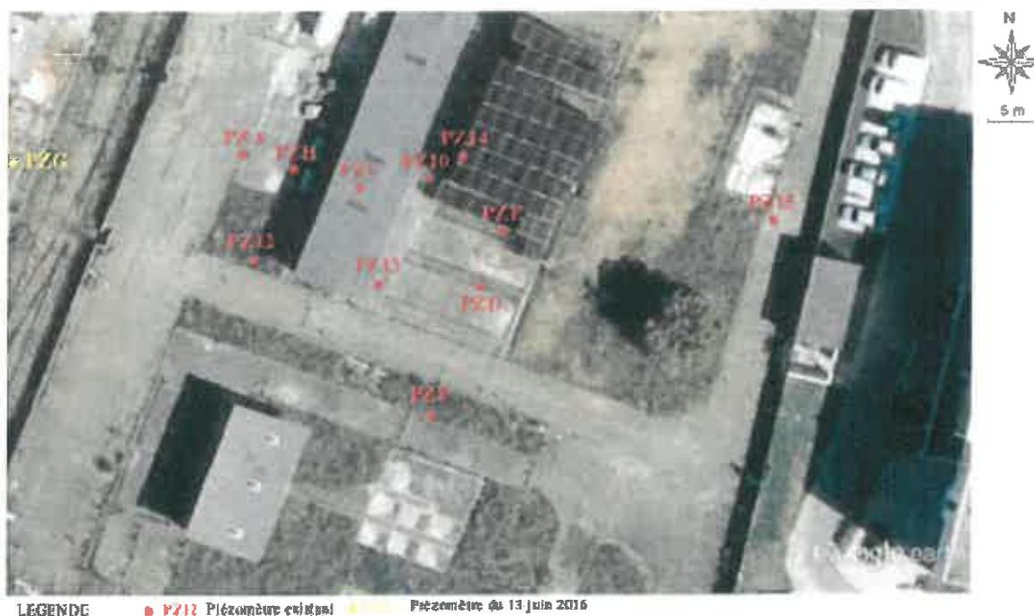
Figure n°1 : Plan d'implantation des piézomètres sur site.
