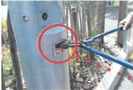
Le coupe boulon permet de sectionner un maillon de chaîne ou à défaut un cadenas d'un diamètre de 10 à 12 mm.
