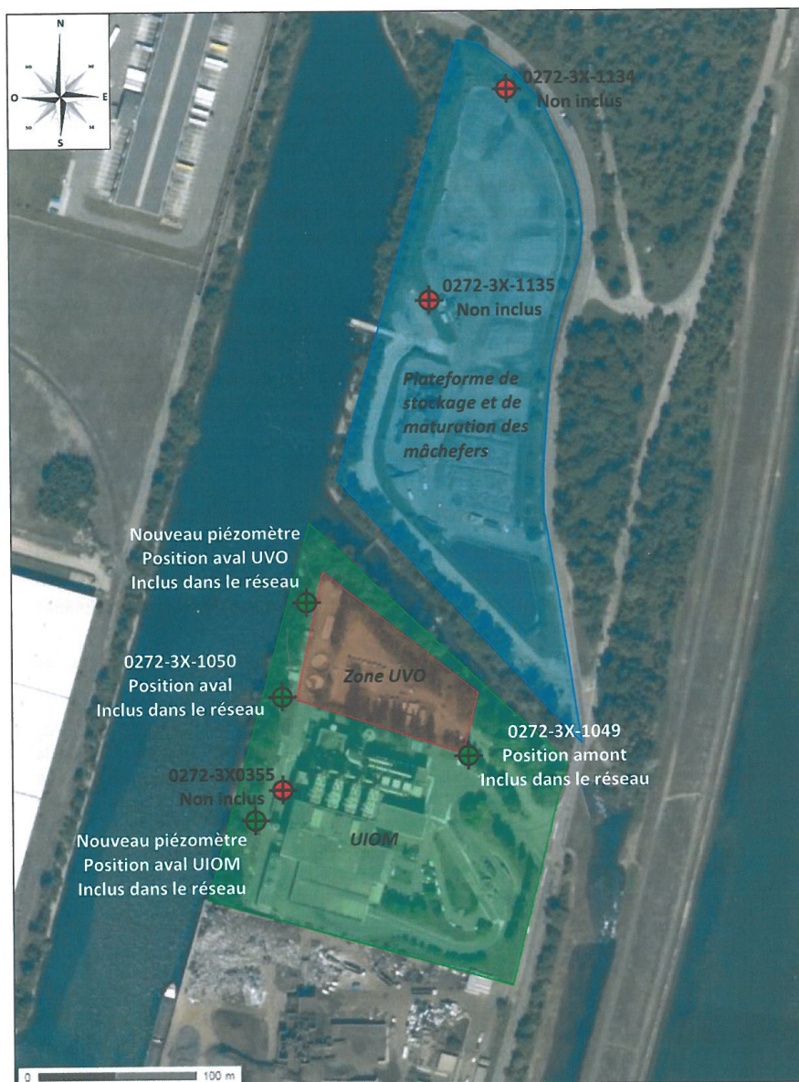
Figure 9 : Localisation du réseau de contrôle de la qualité de la nappe
