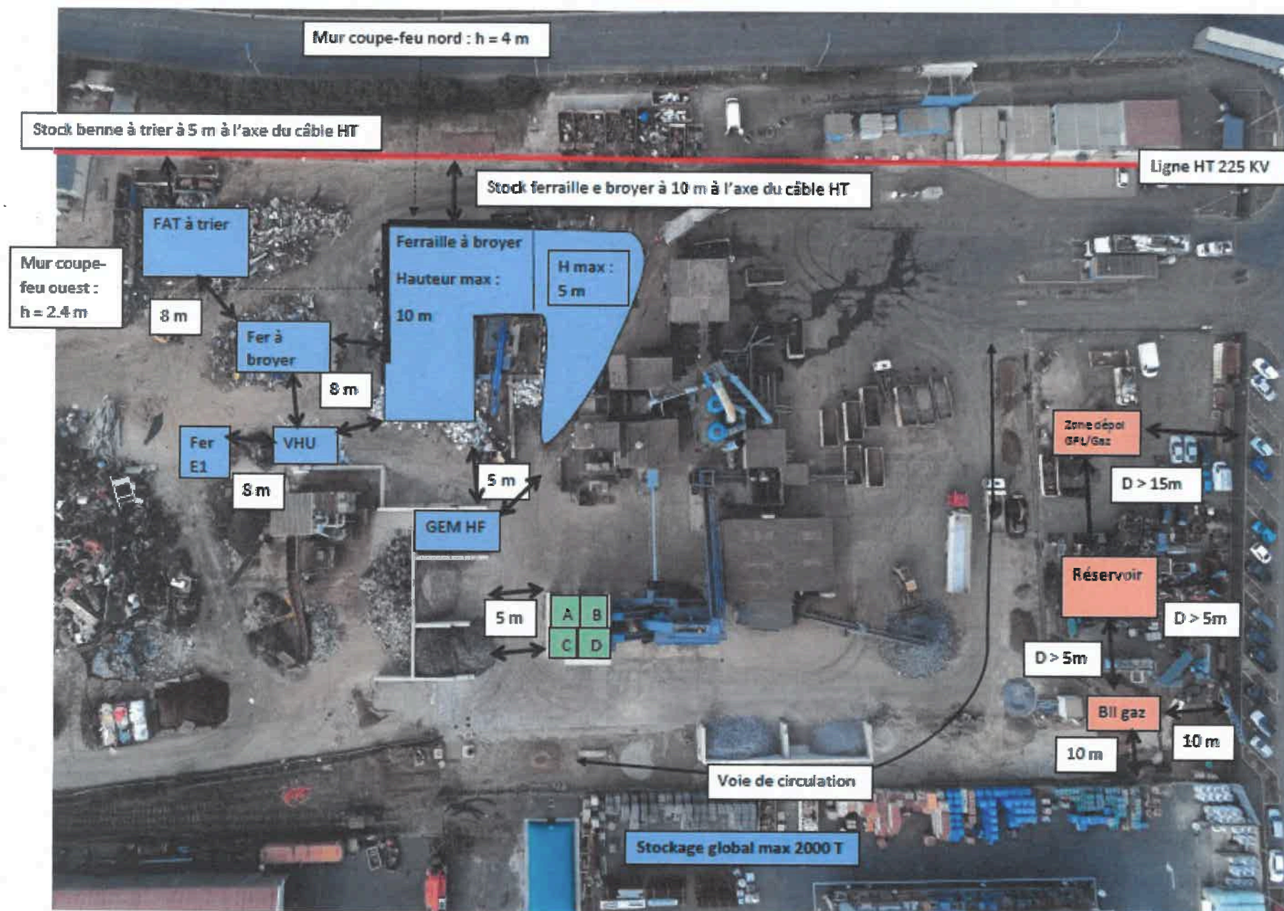
ANNEXE 3 - Plan des stockages de déchets de la zone 3 et distances d'éloignement entre les différentes zones de stockages
