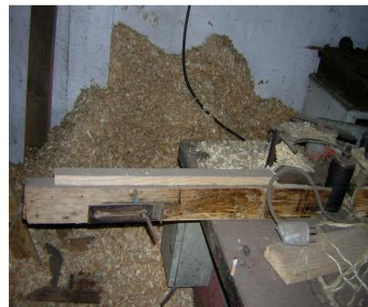
**Accumulation de copeaux à proximité d'une machine à chanfreiner**
