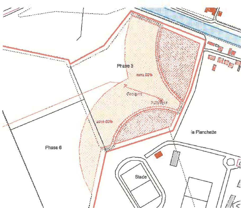
Distance de retrait et d'activité à 50 % du temps avec extraction à la pelle hydraulique
