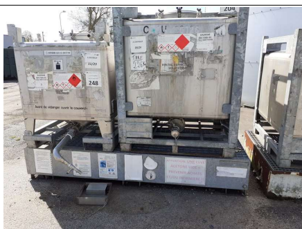
Stockage d'acétone et essence C en extérieur sans auvent ni récupération des égouttures
