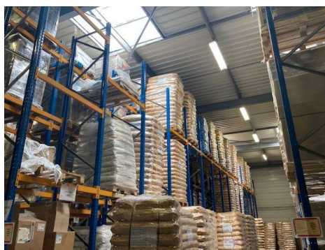
Non-respect de l'espace minimal de stockage entre la partie haute du stockage et la base de la toiture
