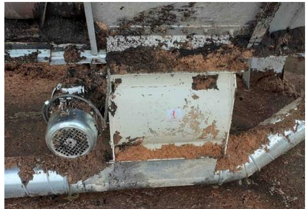
Photo 2 : Évacuation des fines en sortie du cyclo-filtre
