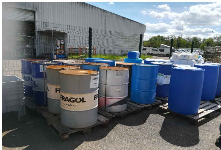
Stockage, à l'extérieur, de fûts de produits susceptibles de créer une pollution des eaux ou des sols sans aucune rétention
