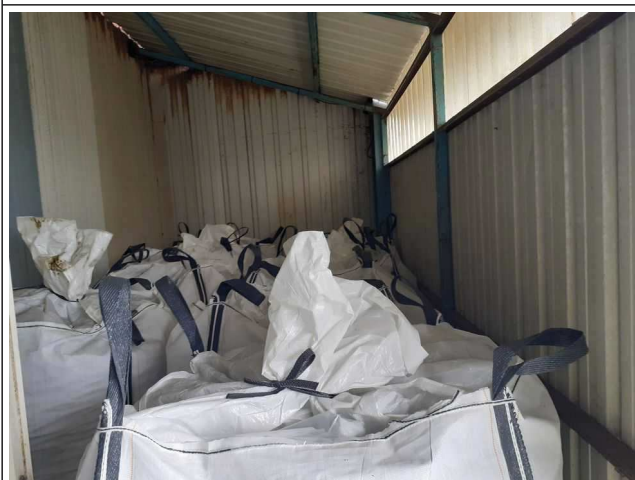
Boues d'hydroxydes métalliques (déchets dangereux) en GRV stockées sous auvent accessible depuis l'extérieur
