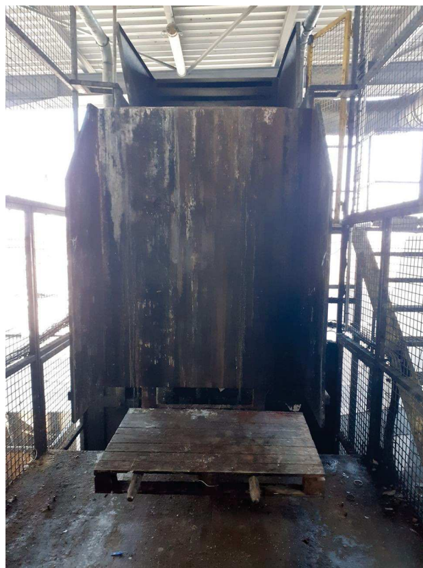
8 – zone de chargement des GRV dans le déchiqueteur
