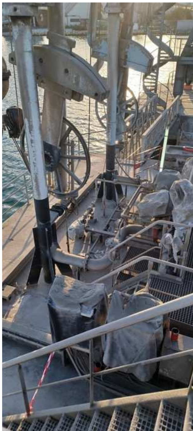
Photo 2 : importants dépôts de poussières sur les installations de dépotage
