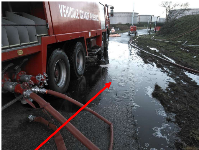
Fuite d'émulseur constatée au niveau du véhicule d'intervention grande puissance
