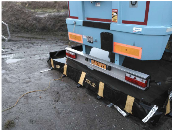
Contenant mobile plein (70 m 3 ) constaté fuyard
