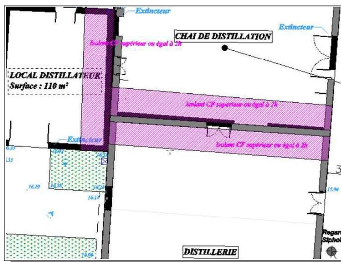
Selon les éléments présentés par l'exploitant lors de la visite (facture du 24/09/2023), un isolant thermique a été mis en place par flocage sous toiture du local distillateur au niveau du mur mitoyen avec le chai. Toutefois la facture présentée ne précise pas le degré coupe-feu obtenu à l'issue des travaux.
