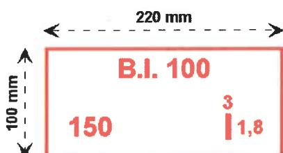
Cette plaque indique qu'une bouche incendie de 100 mm (BI DN 100), raccordée sur une canalisation de 150 mm, est implantée à 3 m devant la plaque et à 1,8 m sur la droite.
