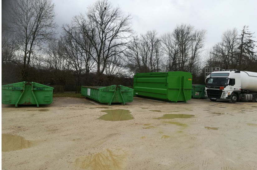
Présence de bennes de copeaux métalliques imbibés d'huile, à l'extérieur sans rétention
