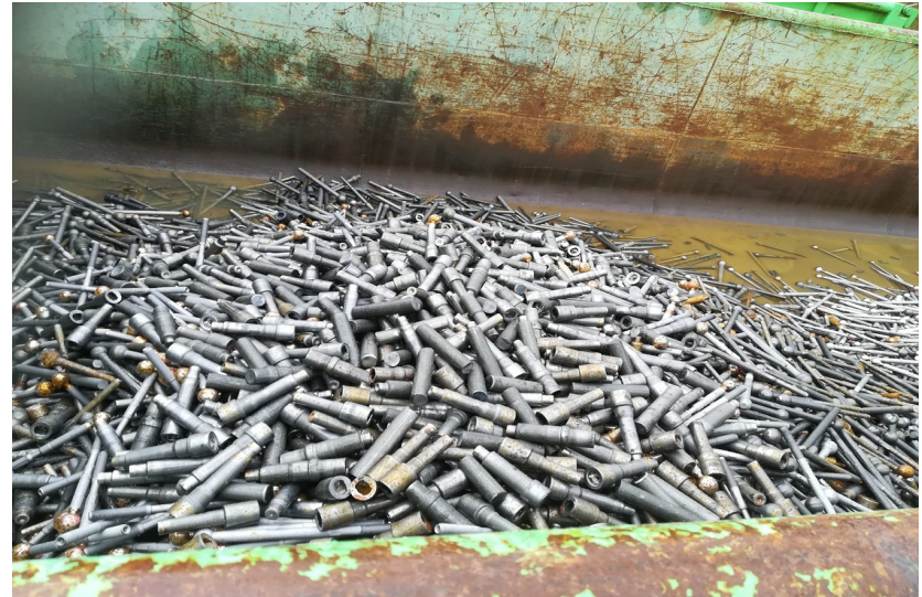
Stockage de rebut de pièces imbibées d'huile de coupe dans une benne, à l'extérieur mélangé à l'eau de pluie
