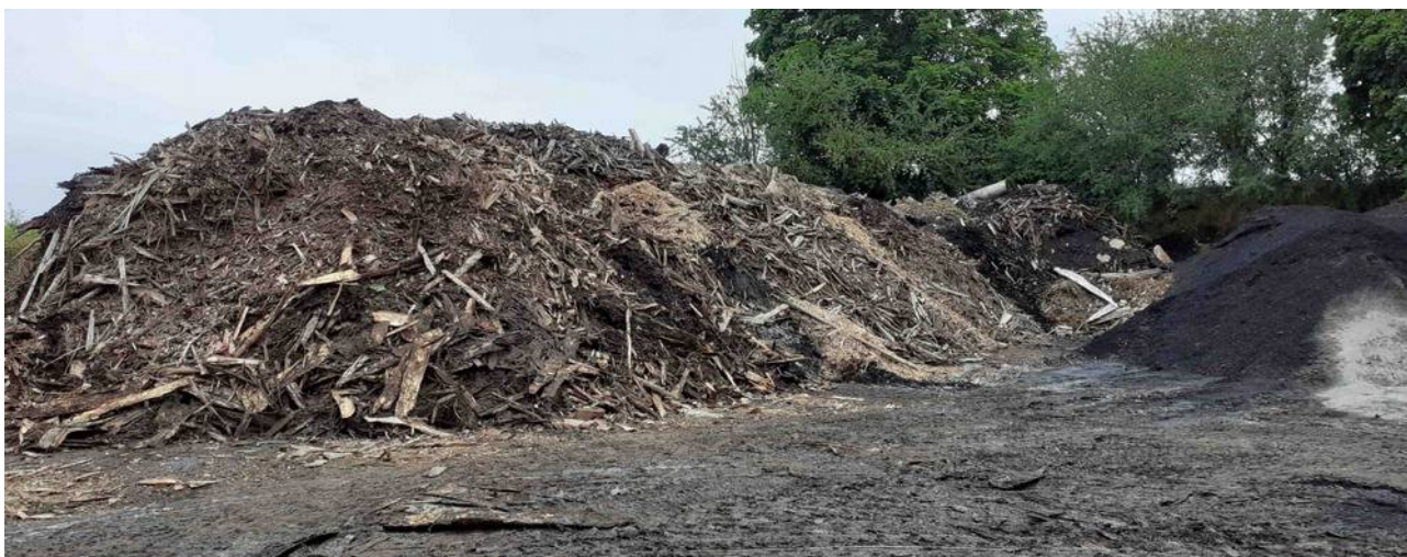
Photo 7 : Entreposage non-conforme des cendres de la chaudière biomasse (cendres sous chaudière)
