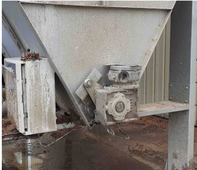
Photo 3 : Moteur en panne de la vis sans fin chargé de diriger les fines vers l'exutoire du cyclo-filtre
