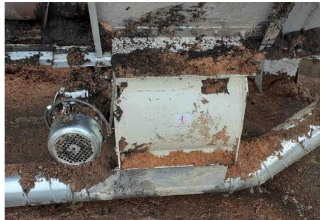
Photo 2 : Évacuation des fines en sortie du cyclo-filtre
