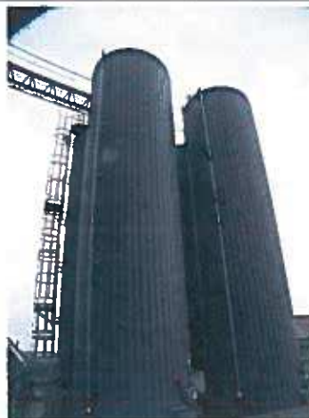
Silos de stockage de liant
