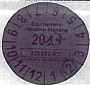
← Photo n°5 : Marque de contrôle d'étanchéité avec date limite de validité échue
