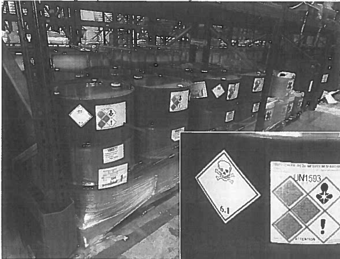
Vue n° 12 : Stockage de fûts de chlorure de méthylène dans la zone A1b du bâtiment A.
