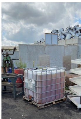
Cubitainer d'huiles hydrauliques non associé à une rétention
