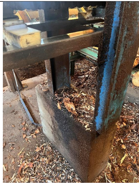
Photo 4 : Amas d'huiles usagées et de copeaux de bois sous le dispositif d'appoint d'huile
