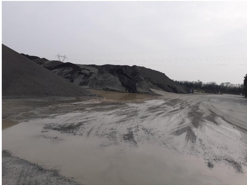
**Plateforme de stockage des croûtes et fraisats d'enrobés destinés à être incorporés aux matériaux constitutifs des futures couches de chaussées**
