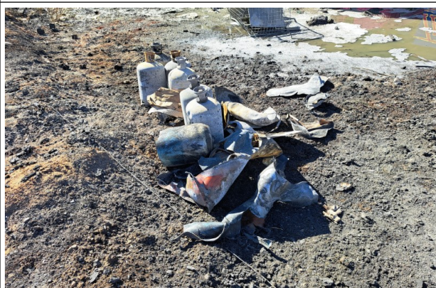
Bouteilles de gaz utilisées pour la propulsion d'un élévateur (plusieurs ont explosé durant le sinistre).
