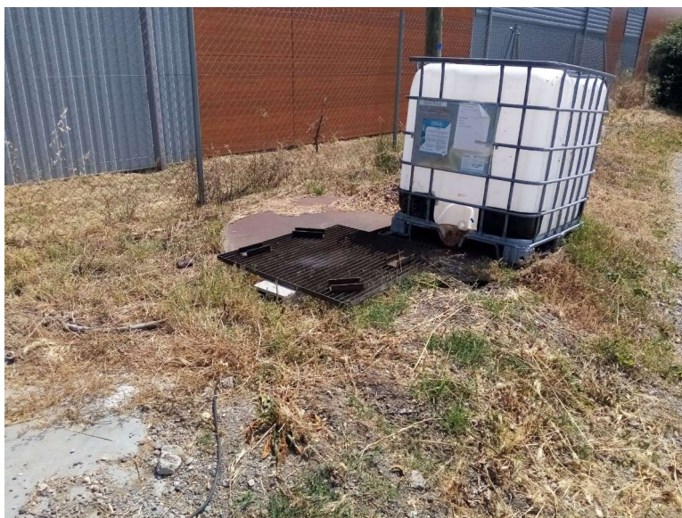
GRV contenant de la lessive de soude devant la station de traitement des eaux de lavage
