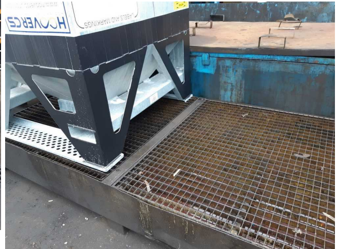
Fûts de catalyseurs entreposés sur l'aire de dépotage de la STEP et bacs métalliques pour transfert du catalyseur vers les installations
