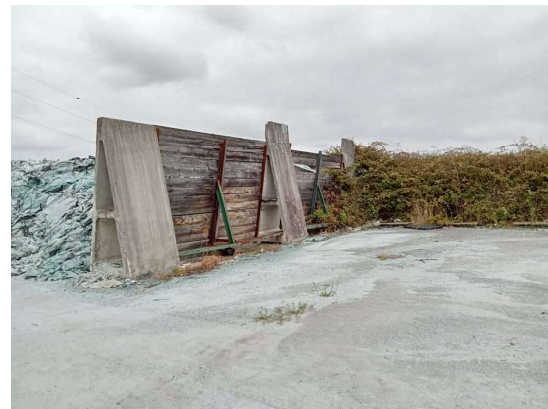
Fig. 4 Verre de pare-brises automobiles derrière un paravent. La zone laissée libre est destinée à limiter le rapprochement du tas de verre des riverains
