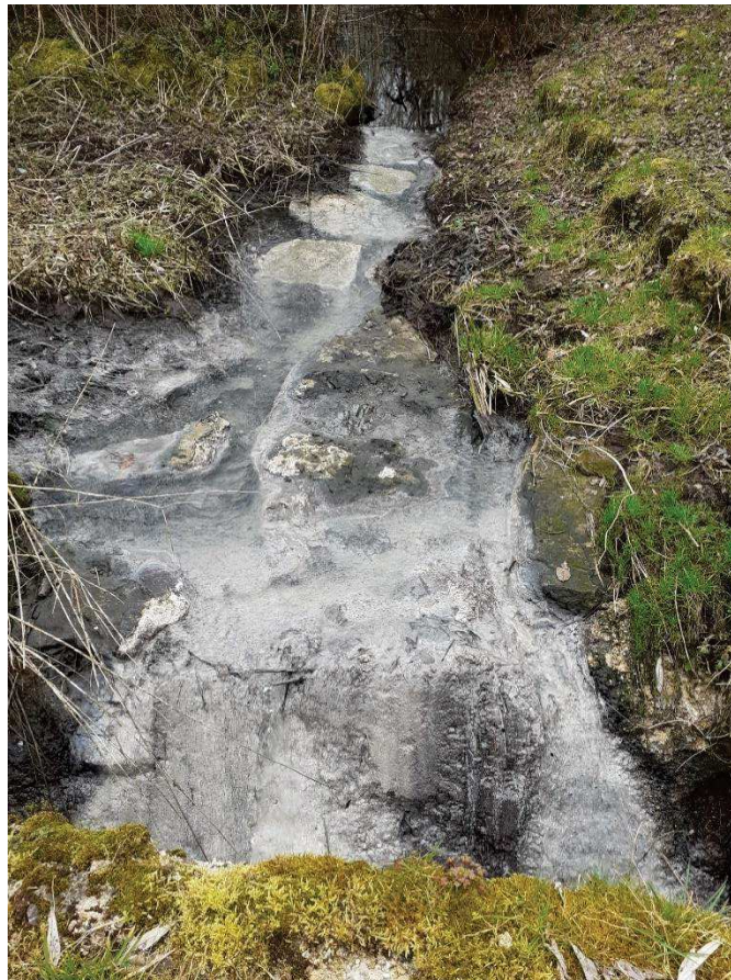
Figure 14 : Le bassin est équipé d'un déversoir d'orage dont les terres étaient fraîches. L'aspect du rejet présente des matières sédimentées grises et des matières en surface.
