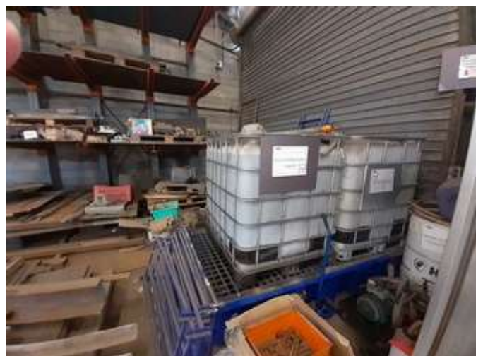
Bacs de produits sur rétention adaptée
