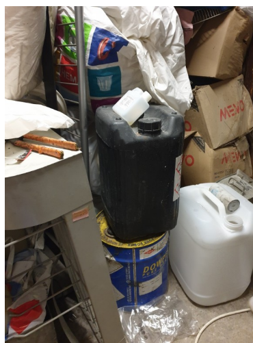
Photo n°2 : Stockage des produits chimiques liquides hors rétention
