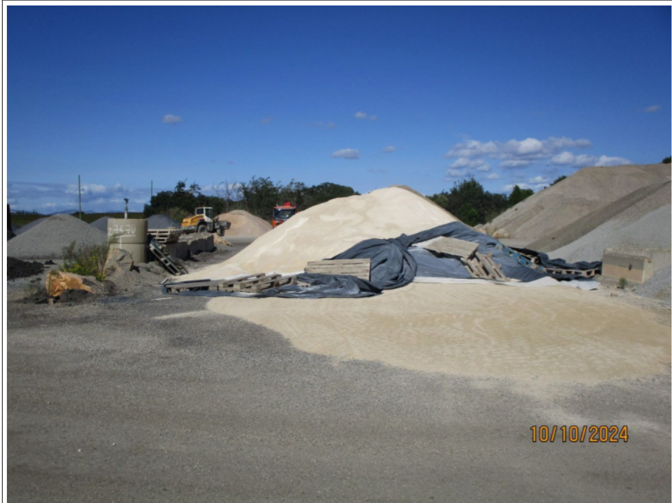
Piste intérieure de la plateforme recouverte d'un bicouches et asperseur à proximité du stockage de matériaux le plus susceptible d'entraîner des envols de poussières et bâche de prévention de ces envols
